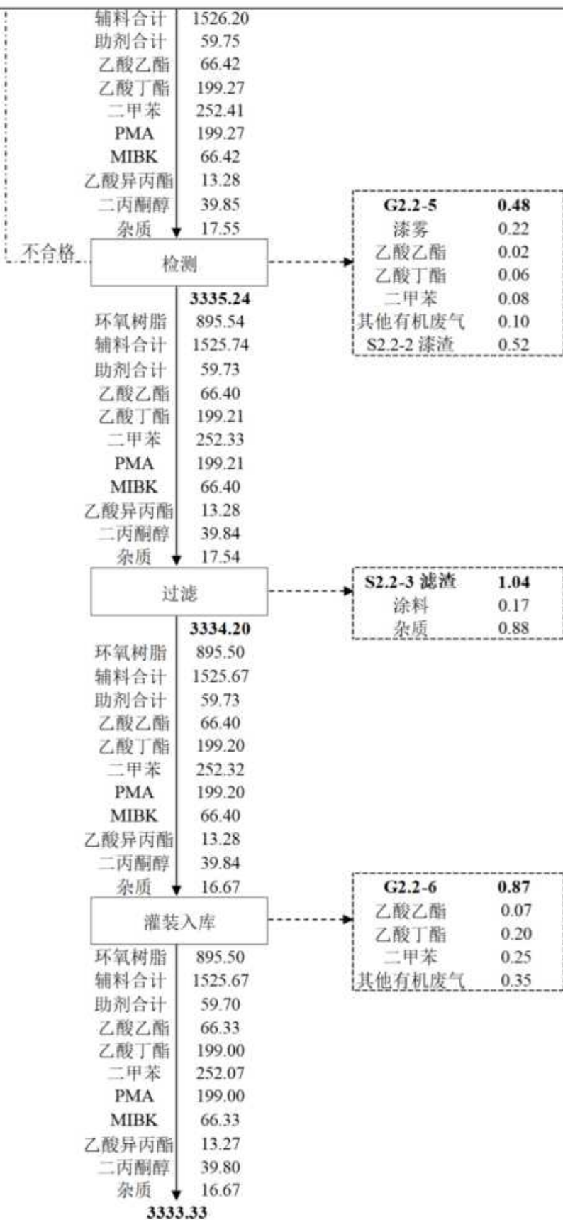
图 2-3-4 高固体份环氧树脂涂料物料平衡 单位: kg/批
