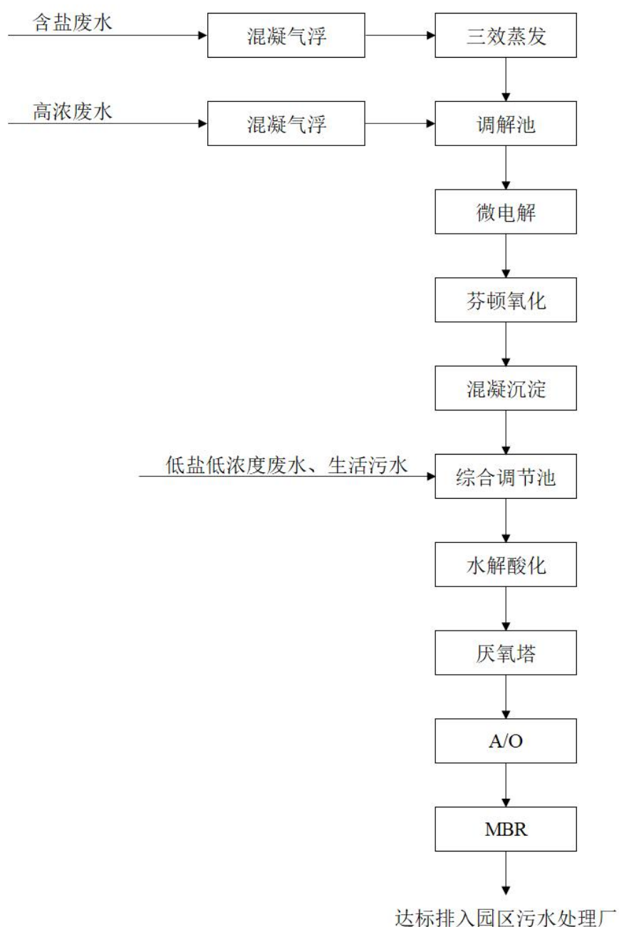
图 7.2.3-3 厂区污水处理厂处理工艺流程图
