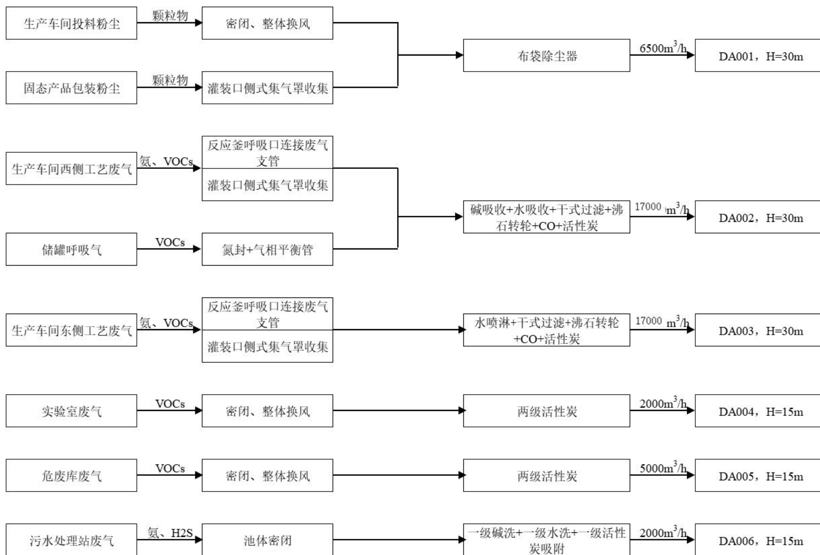
图 2.5.1-1 拟建项目废气收集汇总示意图
