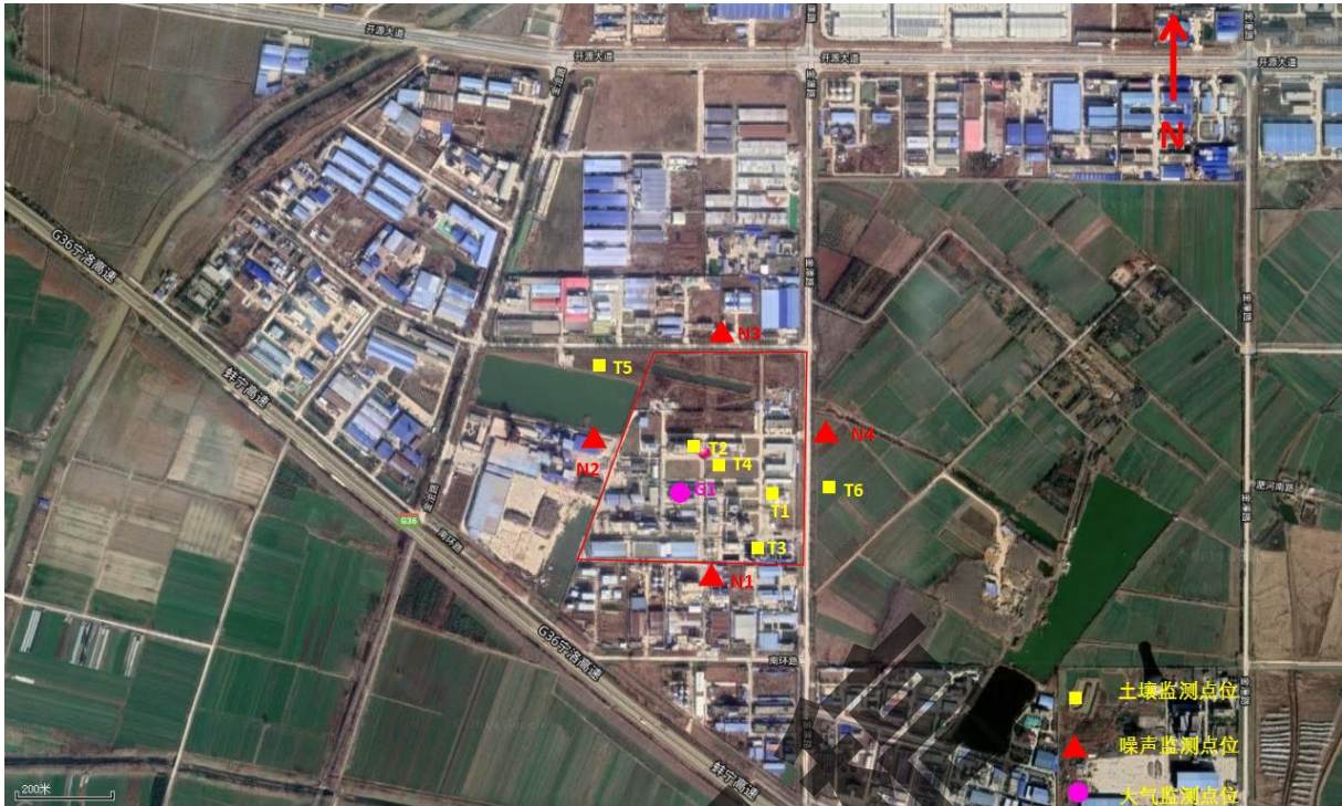
图 4.2.1-1 大气、土壤、噪声现状监测点位布置示意图
