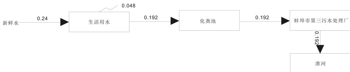
图 4 项目水平衡图 (t/d)
